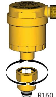
**IT** - Avvitare la valvola automatica di sfogo aria al rubinetto R160, facendo in modo che la paletta in plastica sia guidata dal foro del corpo della valvola automatica di sfogo aria.
