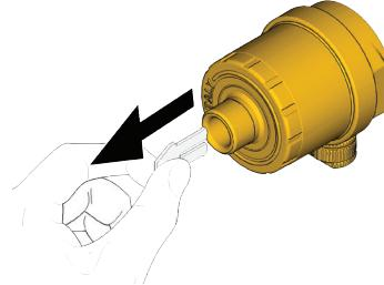
**IT** - Dopo aver avvitato il rubinetto R160 sulla sede di installazione, rimuovere l'eventuale paletta in plastica presente sulla valvola automatica di sfogo aria e procedere con il montaggio.
