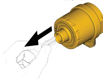
**IT** - Dopo aver avvitato il rubinetto R160 sulla sede di installazione, rimuovere l'eventuale paletta in plastica presente sulla valvola automatica di sfogo aria e procedere con il montaggio.
