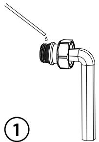
**IT** - Il bocchettone "autotenuta" Giacomini è fornito già dotato di un elemento di tenuta in materiale elastomerico che lo predispone al montaggio sul corpo scaldfante senza aggiunta di canapa, pasta o altri materiali di tenuta.
