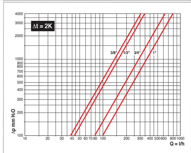
La valeur Kv donne le débit en m<sup>3</sup>/h qui circule à travers le robinet, sous une différence de pression de 1 bar.
