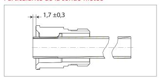
l'insertion correcte de la sonde filetée M12X1 est que, une fois vissé à fond elle dépasse de 1,7 mm du raccord.
