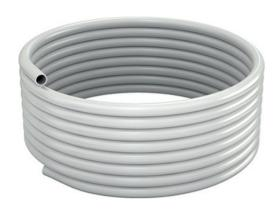
La tubería multicapa R977 está formada por una capa interna de Pert (polietileno reticulado), una capa intermedia en aluminio y una capa exterior en Pert de color blanco. La presencia de la capa de aluminio garantiza una eficiente barrera frente al oxígeno y a otros gases, además de conferir al producto una óptima resistencia al pinzamiento. La tubería multicapa R977 es idónea para instalaciones de fontanería, de calefacción y de refrescamiento.
